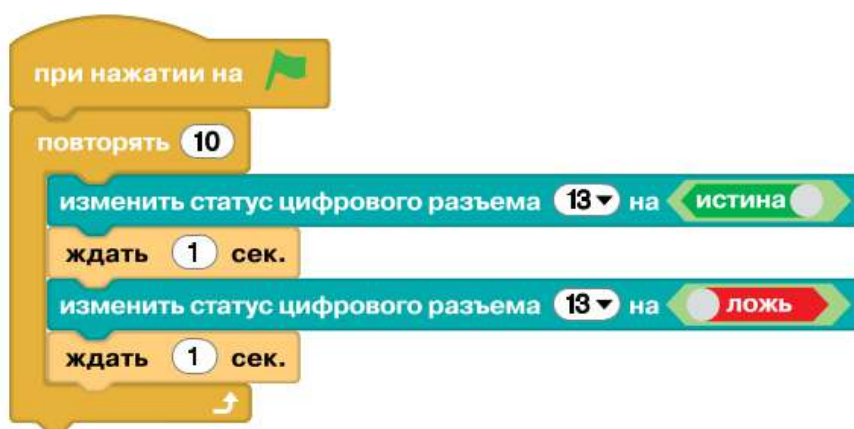
Рис. 10.14. Схема и программа управления одним светодиодом
