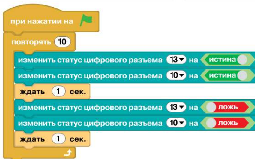
Рис. 10.15. Схема и программа управления двумя светодиодами. Светодиоды мигают синхронно
