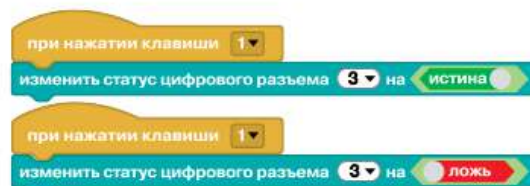
Рис. 10.25. Программа разрешения и запрещения вращения мотора, подключённого к разъёму MR-1
