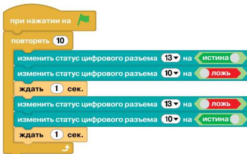
Рис. 10.16. Программа управления линейкой светодиодов. Светодиоды мигают попеременно
