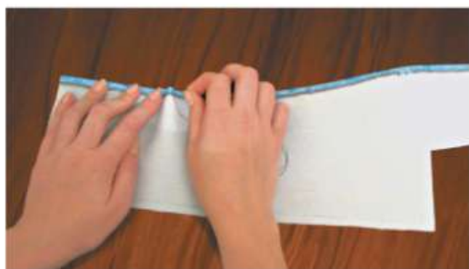
Рис. 4.92. Обработка внутреннего среза подборта: а — замётывание среза; б — застрачивание среза
