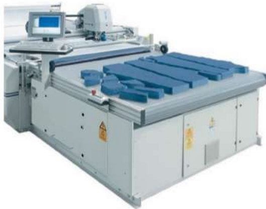
Рис. 4.101. Автоматизированный раскройный комплекс
