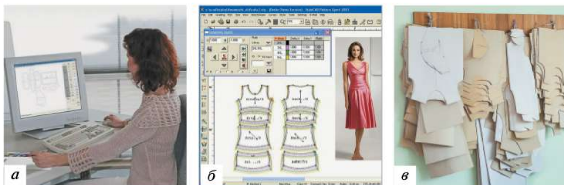
Рис. 4.99. Работа экспериментального цеха: а — разработка конструкции; б — создание экспериментального образца модели; в — готовые лекала
