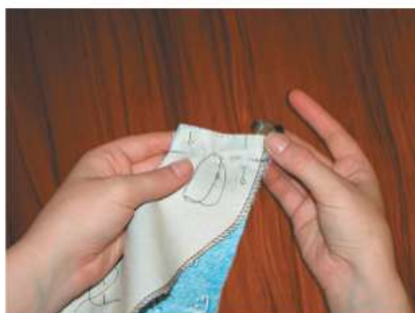
Рис. 4.93. Соединение подборта с обтачкой спинки
