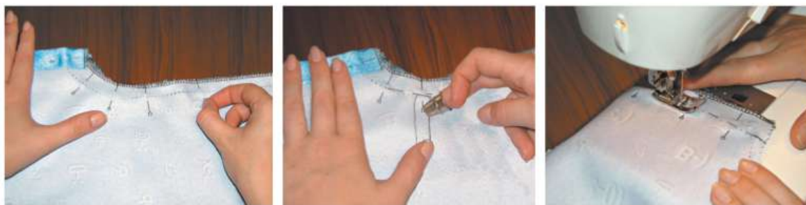
Рис. 4.85. Обработка боковых швов блузки: а — скалывание булавками; б — смётывание; в — стачивание
