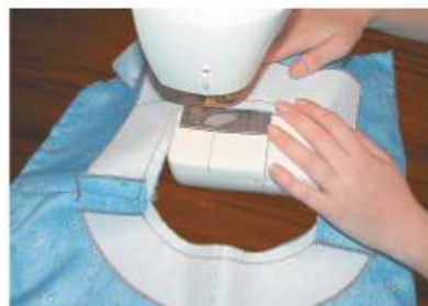
Рис. 4.79. Обработка горловины: а — примётывание обтачки; б — горловина, подготовленная к обтачиванию; в — обтачивание горловины
