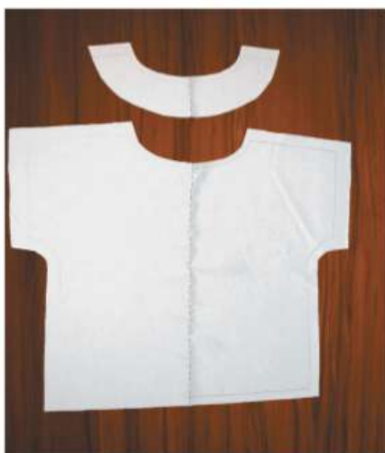
Рис. 4.73. Детали с проложенными линиями середины: а — спинка и обтачка спинки; б — перед и обтачка переда
