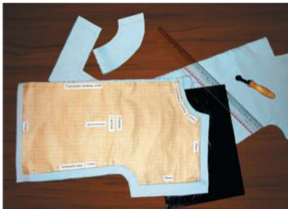
Рис. 4.71. Перевод контуров выкройки: а — инструменты и детали кроя; б — приём работы резцом
