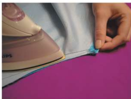
Рис. 4.86. Оттягивание бокового шва
