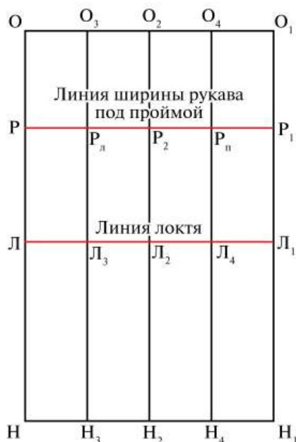
Рис. 4.50. Построение базисной сетки рукава
