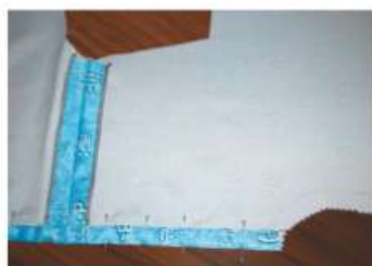
Рис. 4.84. Обработка низа рукава: а — скалывание булавками; б — застрочивание; в — застрочивание низа рукава
