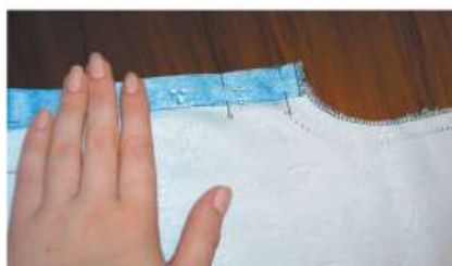
Рис. 4.84. Обработка низа рукава: а — скалывание булавками; б — застрочивание; в — застрочивание низа рукава
