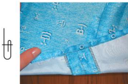
Рис. 4.87. Обработка низа блузки вподгибку с закрытым срезом
