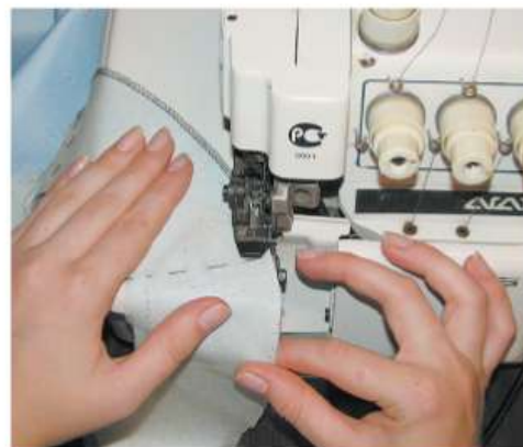
Рис. 4.74. Обмётывание срезов на краеобметочной машине
