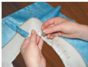
Рис. 4.79. Обработка горловины: а — примётывание обтачки; б — горловина, подготовленная к обтачиванию; в — обтачивание горловины
