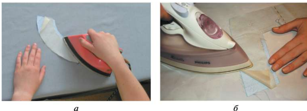
Рис. 4.76. Дублирование обтачек: а — спинки; б — переда
