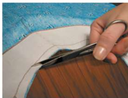
Рис. 4.80. Выполнение надсечек: а — по срезу горловины и в углах; б — в местах крутого поворота
