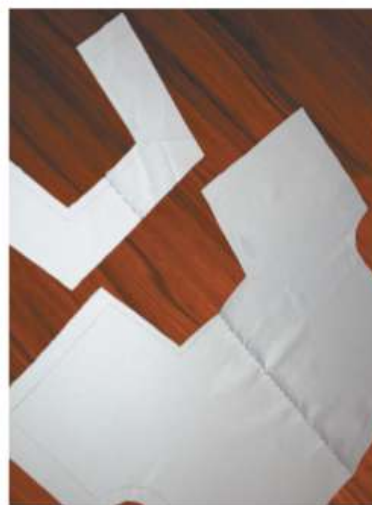
Рис. 4.73. Детали с проложенными линиями середины: а — спинка и обтачка спинки; б — перед и обтачка переда
