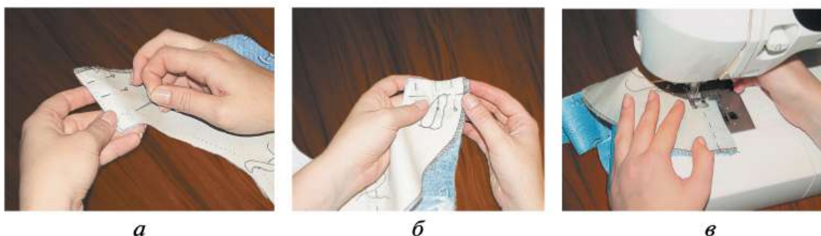
Рис. 4.77. Соединение деталей обтачки: а — булавками; б — ручными стежками; в — на швейной машине
