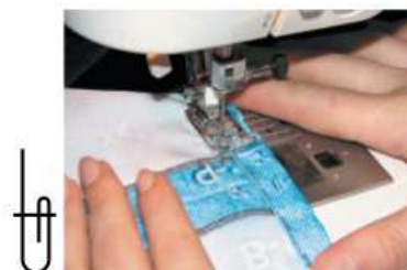
Рис. 4.84. Обработка низа рукава: а — скалывание булавками; б — застрочивание; в — застрочивание низа рукава
