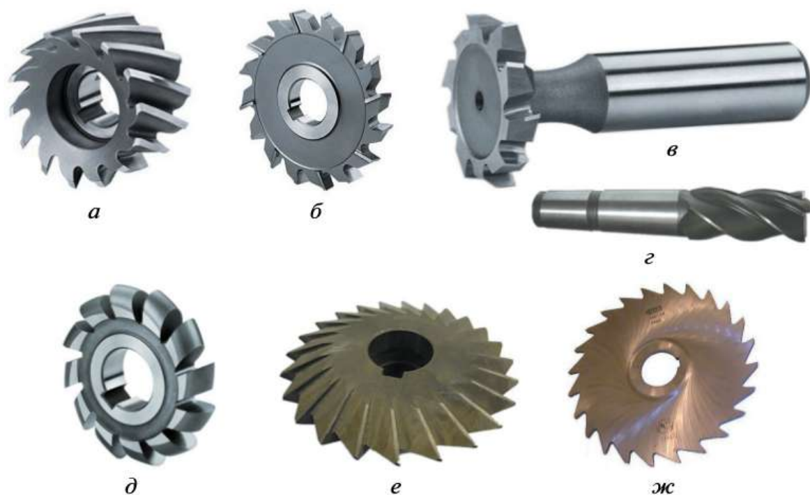
Рис. 3.3. Основные типы фрез: а — цилиндрическая; б — дисковая трёхсторонняя; в — для Т-образных шпоночных пазов; г — концевая; д — фасонная выпуклая; е — призматическая насадная; ж — дисковая прорезная и отрезная
