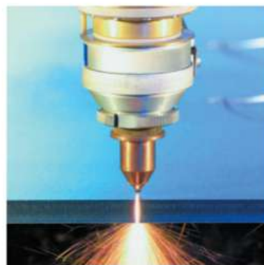
Рис. 2.4. Процесс лазерной резки металлического листа
