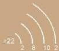
Электронно-графическая схема титана (Ti)
