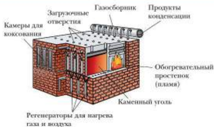
Рис. 82. Схема устройства коксовой печи
