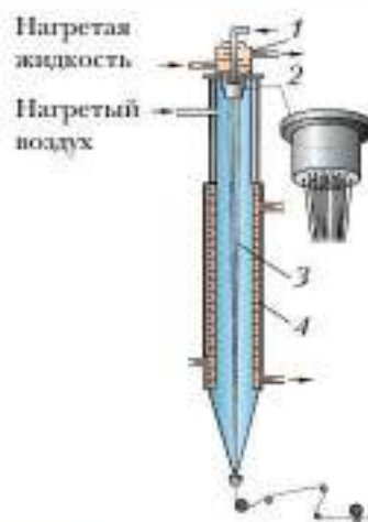
Рис. 86. Схема формирования волокна: 1 — прядильная головка; 2 — фильера; 3 — образующиеся волокна; 4 — шахта
