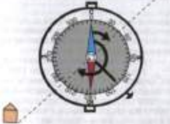
Рис. 36. Определение азимута по компасу
