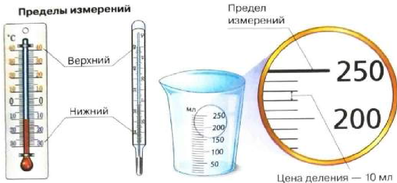
Рис. 16. Предел измерения и цена деления шкал измерительных приборов
