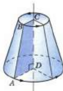
Усеченный конус получен вращением прямоугольной трапеции ABCD вокруг стороны CD
