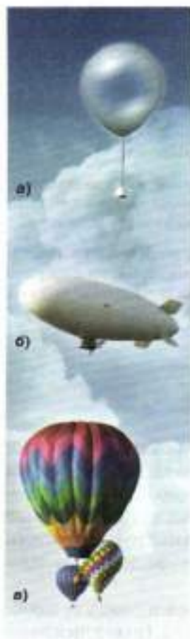
Рис. 161. Воздухоплавательные: а — стратостат; б — дирижабль; в — воздушные шары
