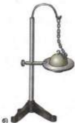
Рис. 18. Тепловое расширение металлического шара
