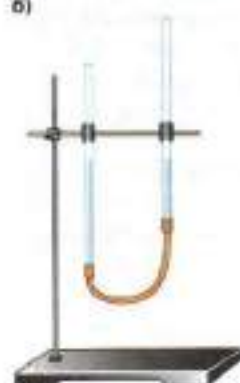
Рис. 116. Установление уровня жидкости в сообщающихся сосудах
