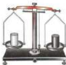
Рис. 50. Взвешивание тел равного объёма, изготовленных из разных веществ
