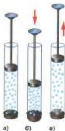
Рис. 97. Изменение давления газа при изменении его объёма
