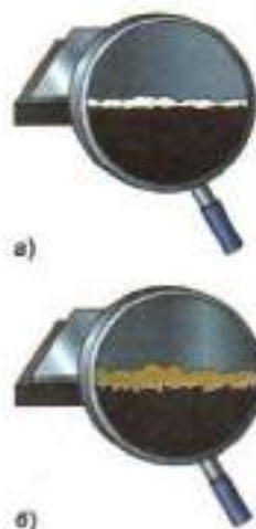
Рис. 82. Уменьшение силы трения с помощью смазки
