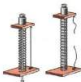
Рис. 192. Совершение работы сжатой пружиной при её распрямлении
