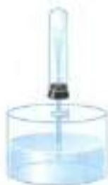
Рис. 126. Поступление воды внутрь сосуда из-за разности атмосферного давления и давления в закрытом сосуде
