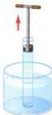
Рис. 125. Подъём воды вслед за поршнем
