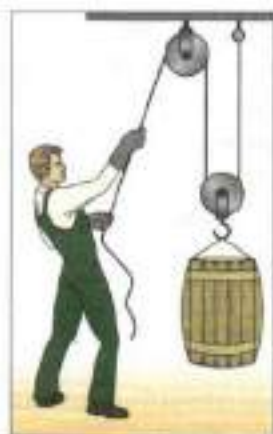
Рис. 181. Комбинация подвижных и неподвижных блоков — полиспаст
