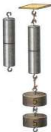
Рис. 26. Сцепление свинцовых цилиндров
