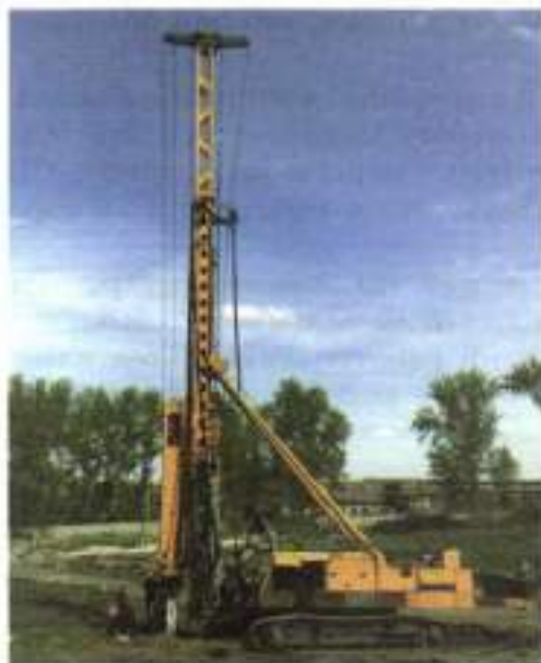
Рис. 194. Машина для забивания свай
