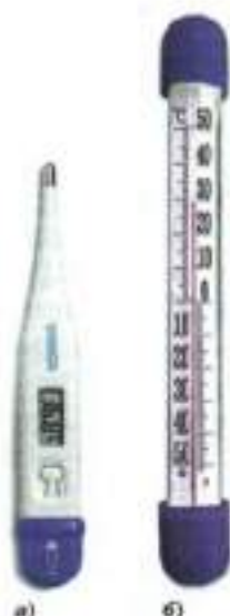
Рис. 11. Термометры: а — электронный; б — спиртовой
