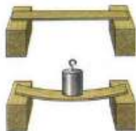
Рис. 64. Возникновение силы упругости
