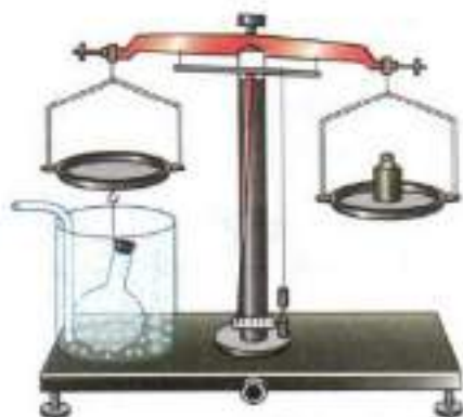
Рис. 150. Обнаружение силы, выталкивающей тело из газа
