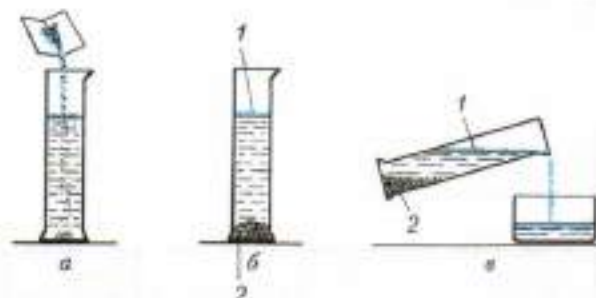
Рис. 2. Отделение железных опилок (1) от древесных (2): а — всыпание смеси железных и древесных опилок в воду; б — разделение смеси в воде; в — сливание воды с всплывшими древесными опилками в сосуд
