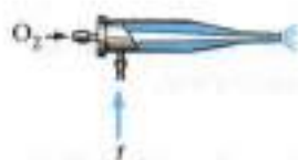
Рис. 32. Ацетилено-кислородная горелка: 1 — сжигаемый газ
