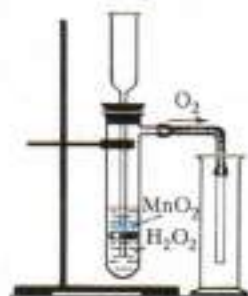
Рис. 26. Ускорение реакции разложения пероксида водорода в присутствии оксида марганца(IV)
