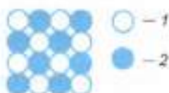
Рис. 12. Кристалл сульфида железа: 1 — атомы серы; 2 — атомы железа
