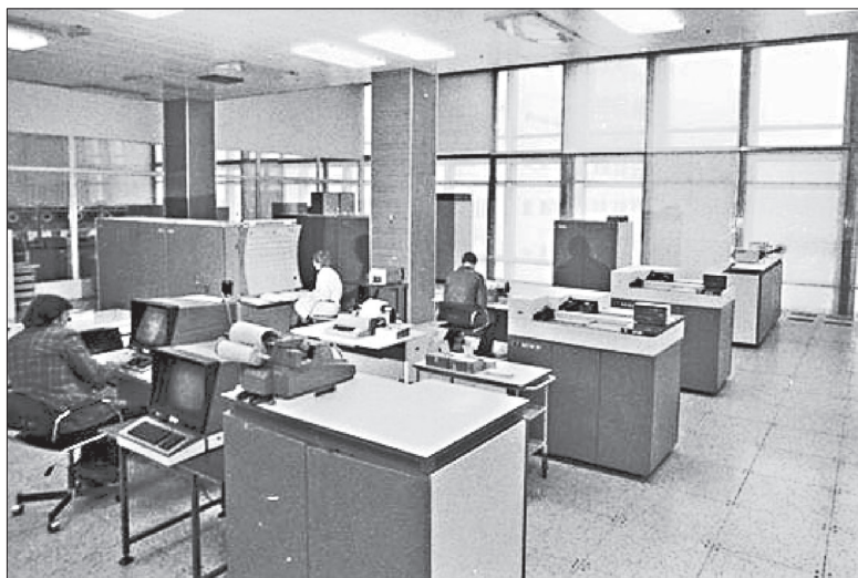
Рис. 2.3. Рабочее помещение с установленной ЕС-1060 ( www.3dnews.ru )
