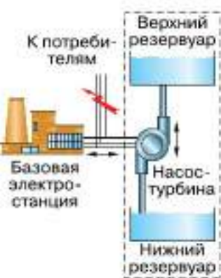
Рис. 9. Схема гидроаккумулирующей электростанции
