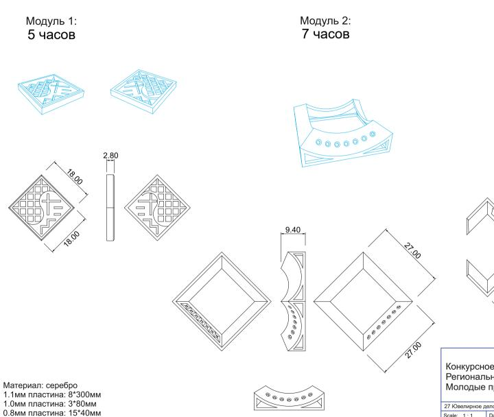
1.1мм квад. проволока: 230мм 0.8мм круг. проволока: 300мм
