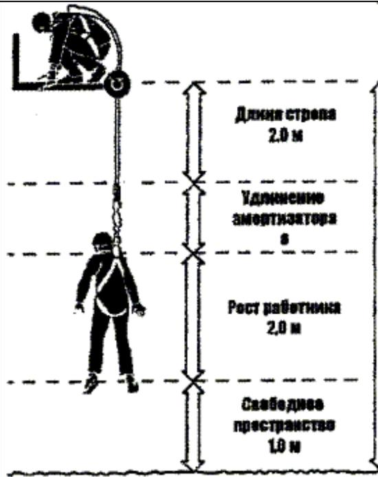
Запас высоты при использовании стропа с амортизатором рассчитывается с учетом суммарной длины стропа и соединительных элементов, длины сработавшего амортизатора, роста работника, а также свободного пространства, остающегося до нижележащей поверхности в состоянии равновесия работника после остановки падения.
