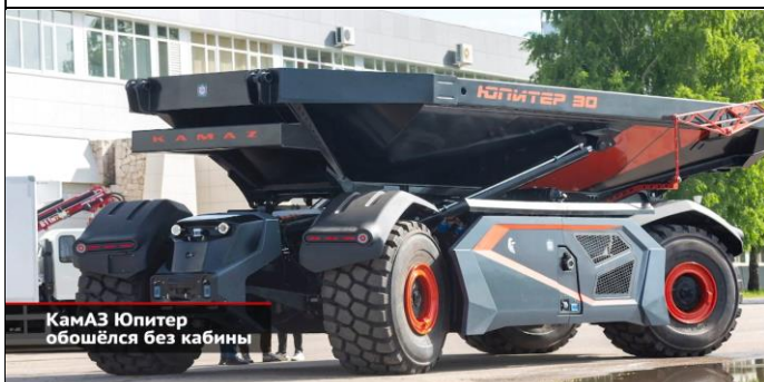
Тестировка беспилотного карьерного самосвала ЮПИТЕР 30
