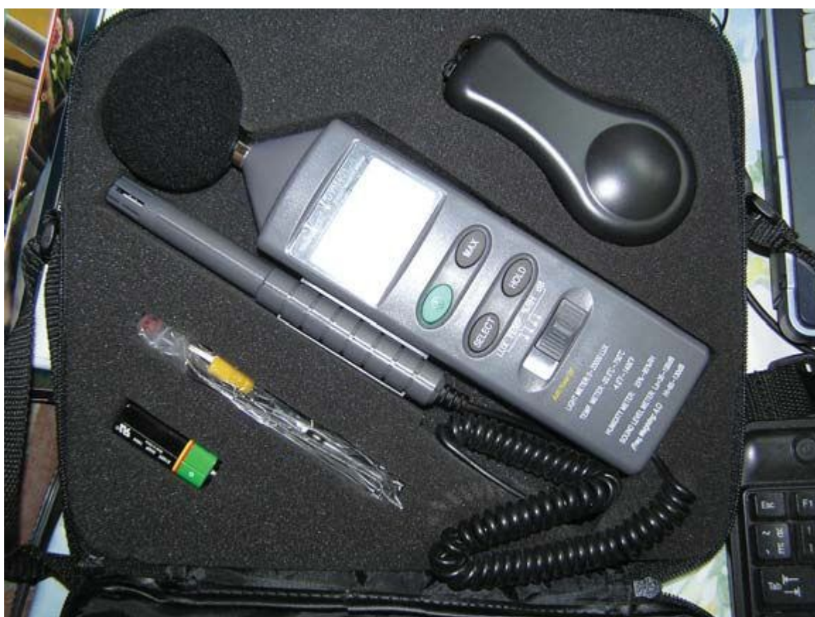
Рис. 3.23. Универсальный шумомер DVM401 (в специальном кейсе)
