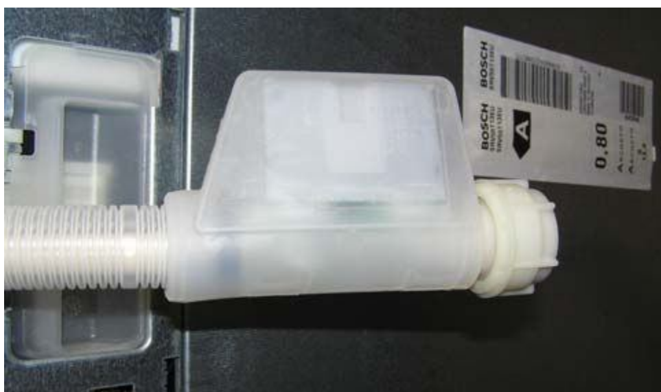
Рис. 1.41. Электромагнитный клапан системы Aqua-Stop
