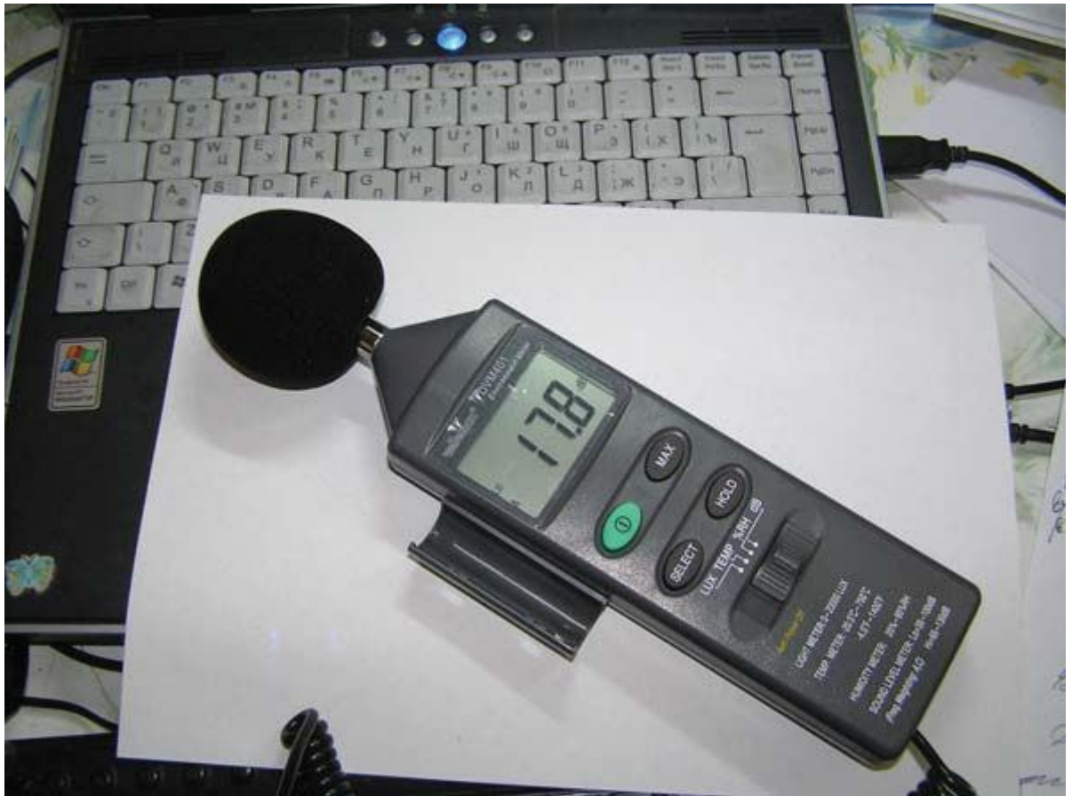
Рис. 3.24. Показания шумомера при замера фона в жилой комнате
