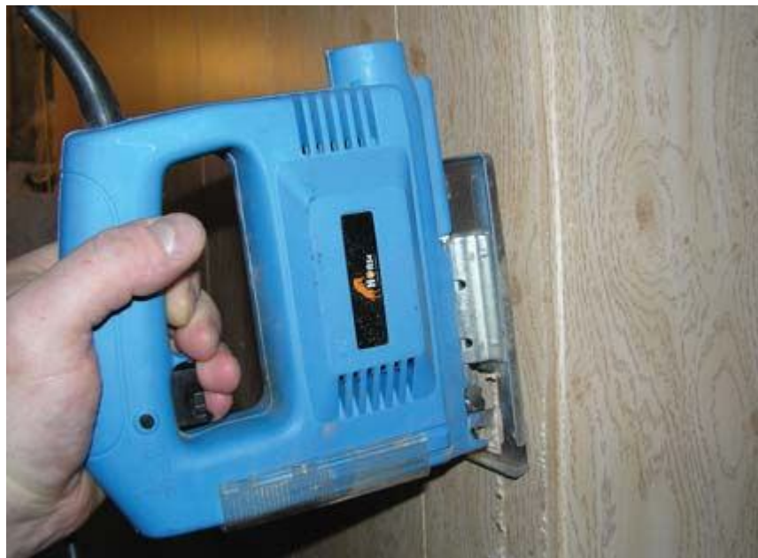
Рис. 1.34. Обрезка на стене с помощью электролобзика M1Q-DD-55
