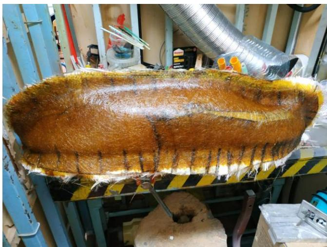
6. После полного отверждения матрицы срезается лишний облой и зашлифовывается наружная часть матрицы. Пока части матрицы не разъединены, сверлятся отверстия и вкручиваются крепёжные болты
