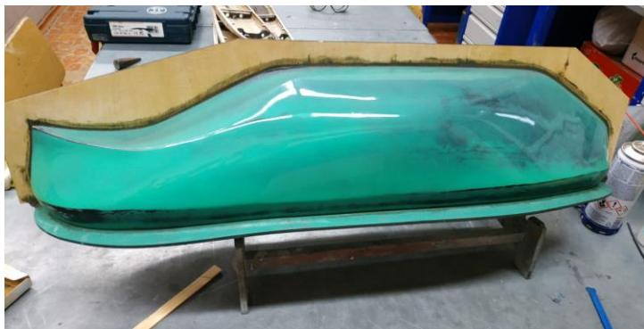
2. Готовятся шаблоны из бумаги для раскрай стеклоткани. Необходимо определиться с необходимой толщиной (плотностью) матрицы – она должна быть минимум в 3-4 раза толще (плотнее) выклеиваемого корпуса. Нарезка стекломатериалов по этим шаблонам:
