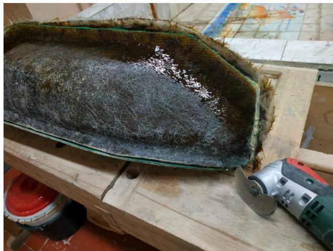
7. Разъединение двух половин матрицы, извлечение мастер-модели, полировка внутренних частей матрицы. Матрица готова:
