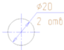
Рисунок 9. Нанесение диаметральных размеров
