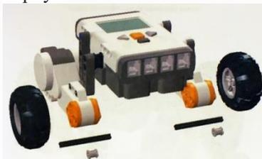
**Шаг 5.** Конструкция для крепления третьего колеса:
