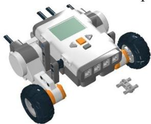
Как и впервой конструкции, датчик располагается вертикально:
