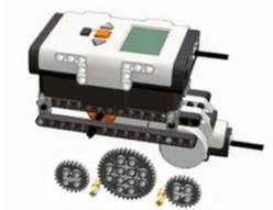
**Шаг 5.** Выравнивание крайних шестеренок. Все 4 основные шестерни (24 зуба) должны быть расположены так, чтобы пары отверстий на них были строго параллельны друг другу. Расположение 40-зубых центральных шестерней не играет роли.
