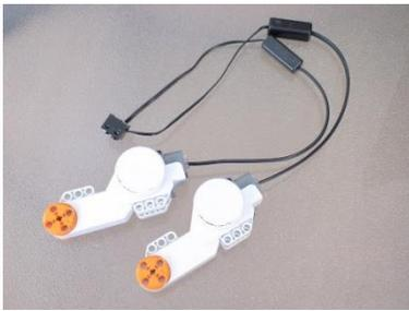
Теперь нужно взять еще один кабель-переходник и его уже подключить к блоку. А оставшийся свободный контакт-пластину подключить к связке моторов:
