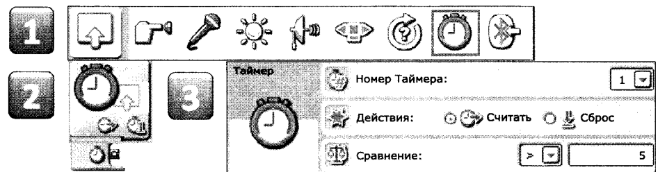
Рис. 165. Последовательность настройки таймеров
