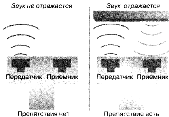
Рис. 183. Схема работы ультразвукового датчика
