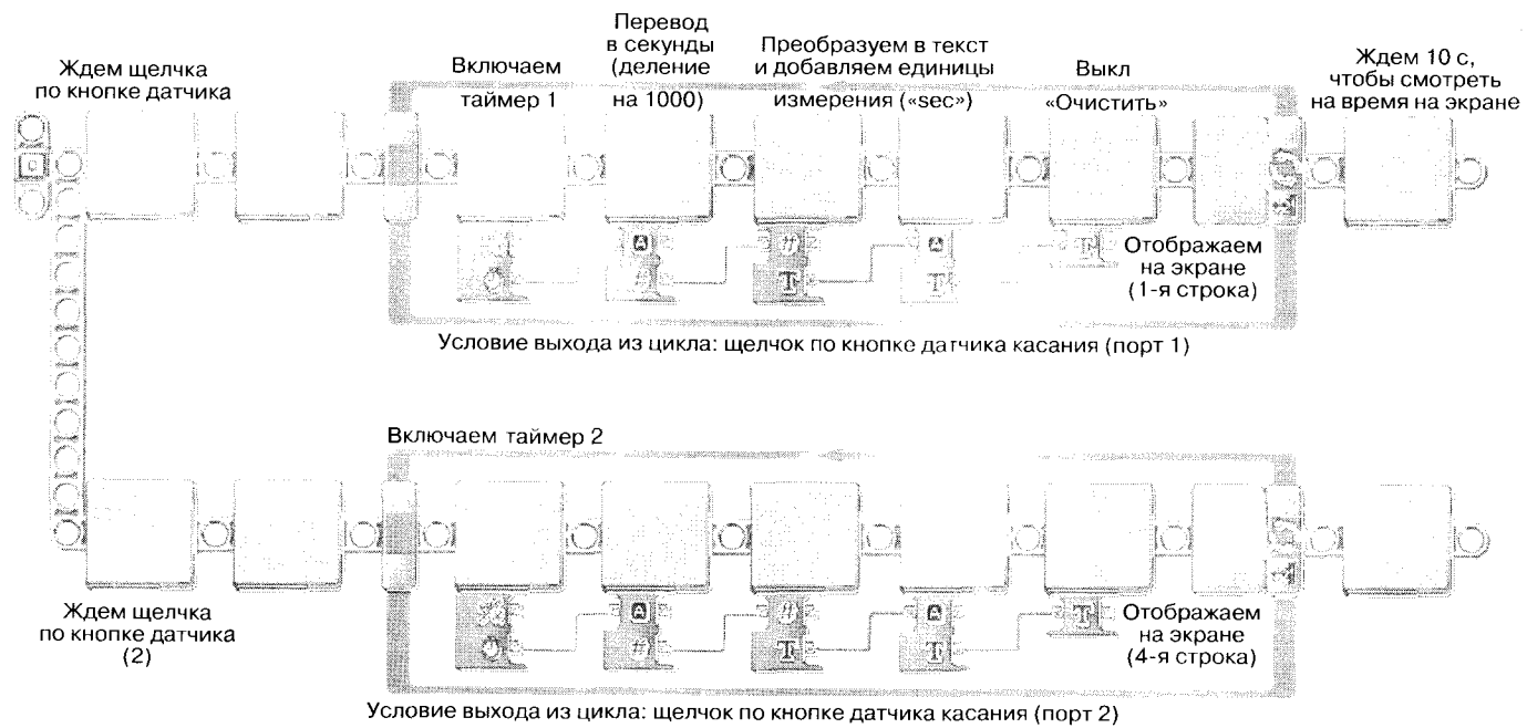
Рис. 258. Общая схема алгоритма работы секундомера
