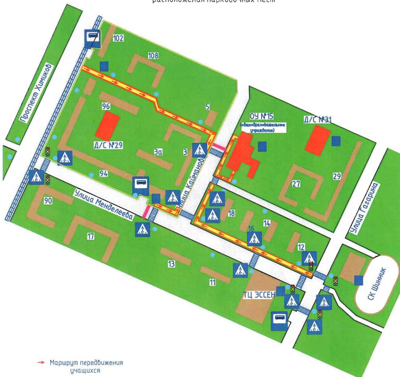
2. План-схема организации дорожного движения в непосредственной близости от образовательного учреждения с размещением соответствующих технических средств организации дорожного движения, маршрутов движения детей и расположения парковочных мест
