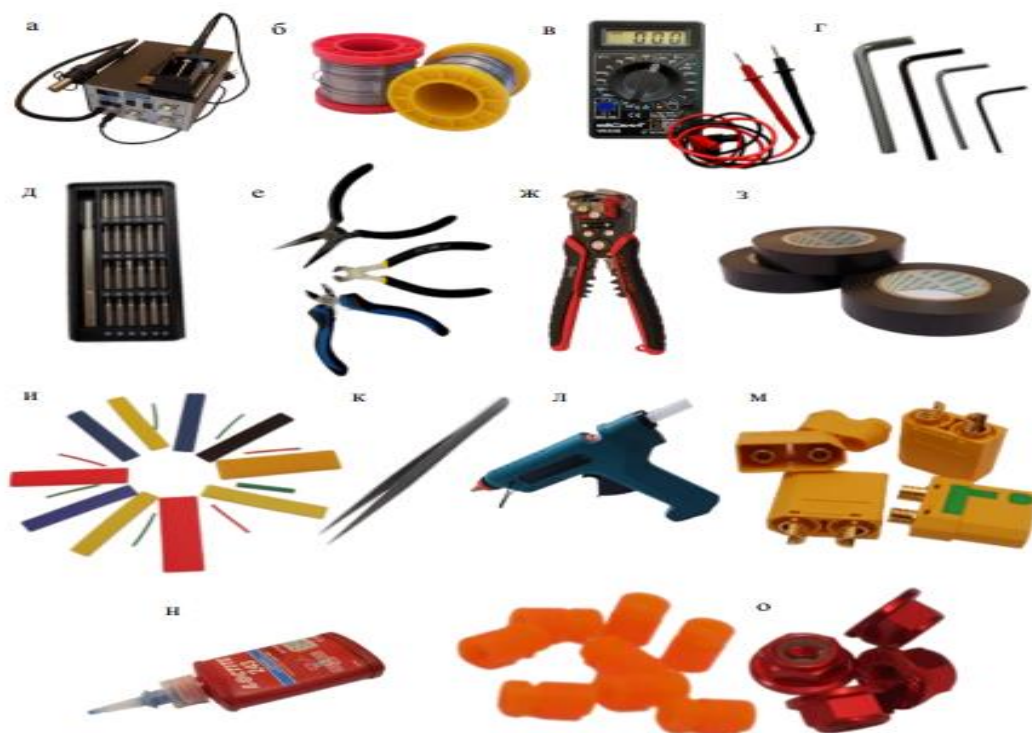
Рисунок 2.1 – Основные инструменты: а – паяльная станция; б – припой; в – мультиметр; г – набор шестигранных ключей; д – набор отверток; е – кусачки, плоскогубцы; ж – стриппер; з – изолянты; и – набор термоусадочных трубок; к – пинцет; л – термопистолет; м – набор разъемов; н – фиксатор резьбы; о – адаптер и стопорные гайки пропеллера
