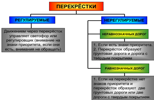
Рисунок 6. Схематическое представление типов перекрестков
