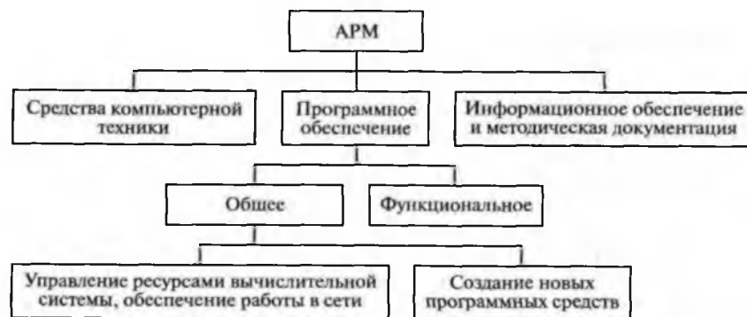
Рис. 1.1. Структура автоматизированного рабочего места специалиста
